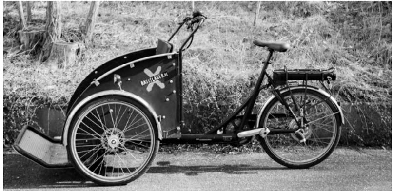
Die „christianiabikes“- Rikscha verfügt über einen E-Motor mit einer Zulassung bis 25 km/h. Über ein Display kann man wählen, wie viel Unterstützung man grade benötigt. Ein Drehgriff schaltet den Akku zu. Wenn er losgelassen wird, schaltet der Motor ab. Eine Anfahrhilfe bis 5 km/h macht den Start einfach. Die hydraulischen Scheibenbremsen stoppen das Rad zuverlässig.
